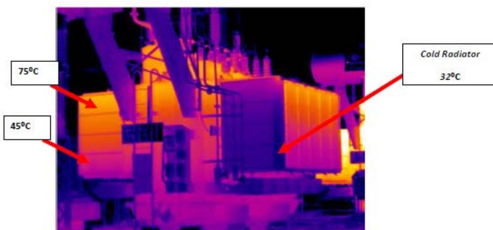
Slika 1. Termalna slika uljnog energetskog transformatora sa dijagnozom manjka ulja i zračnog džepa.
